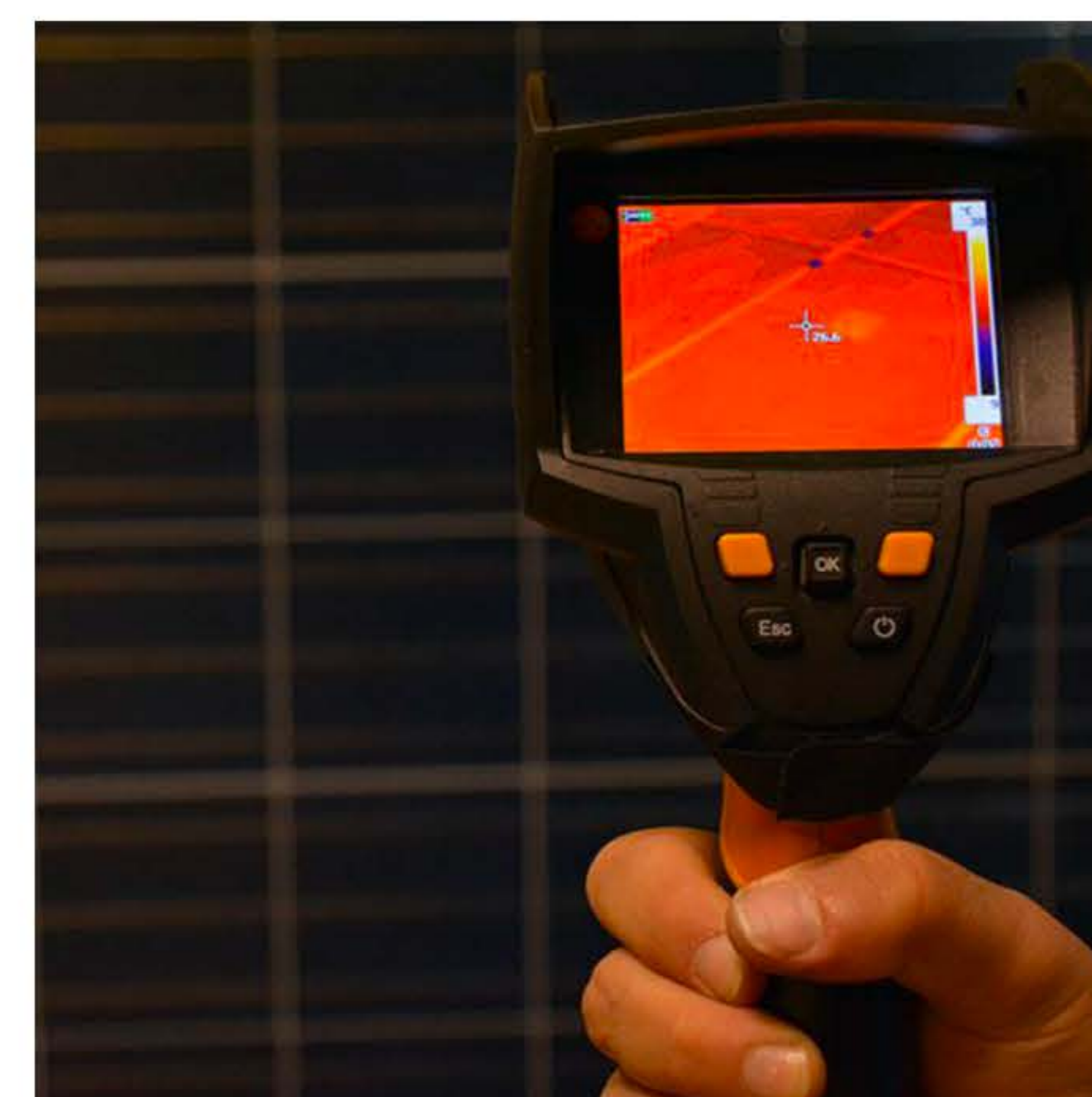
Termocamera per la rivelazione della dispersione energetica, sotto forma di calore, causata da difetti dei moduli fotovoltaici, degli inverters e dei quadri elettrici.
